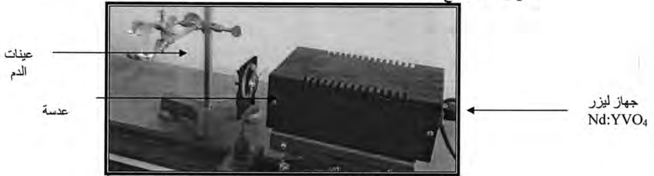
الشكل- 1 : يوضح عملية توجيه ليزر Nd:YVO 4 على عينات الدم عند 37 0 م
