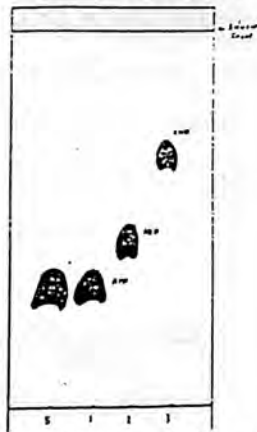
الشكل (4) : نمط الترحيل لنيوكليوتيدات الاديوسين الاحادية والثنائية والثلاثية باستخدام تقنية كروماتوغرافيا الطبقة الرقيقة TLC (نظام الفصل مكون من حامض الايزو - بيوتيريك وهيدروكسيد الامونيوم بنسبة (5.3) حجم / حجم) وعلى التوالي . حيث ان : S عينة ATP القياسية 1, 2, 3 : عينات ATP, ADP, AMP التي تم تنقيتها باستخدام المبادل الايوني Dowex 1 على التوالي.
