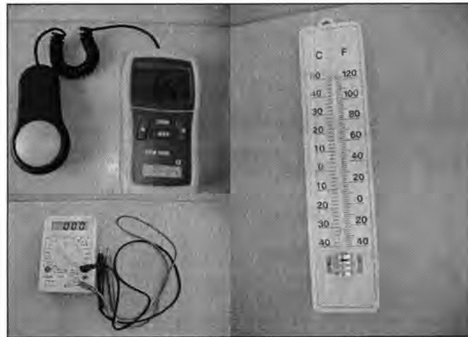
شكل 2- الاجهزة المستخدمة لقياس الحرارة والتيار والفولتية
